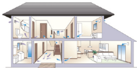
※換気システム空気の流れのイメージ図です。
